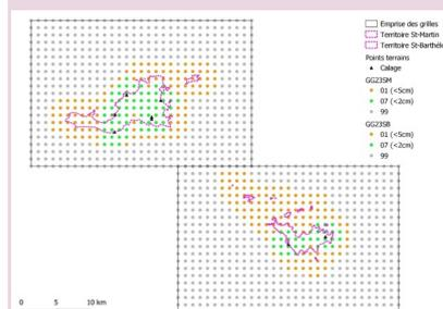
Les grilles GGM23SB (Saint-Barthélemy) et GGM23SM (Saint-Martin) permettent de calculer une valeur d'altitude orthométrique légale à partir d'une hauteur ellipsoïdale RGAF09,
