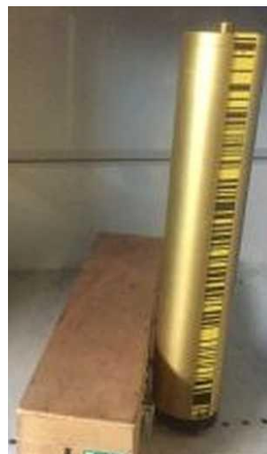
Mire-cylindre de fabrication IGN pour le nivellement des antennes GNSS
